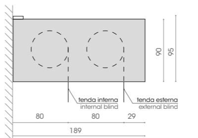
Fissaggio a soffitto. Ceiling fixing
