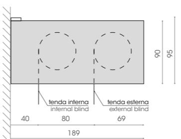
Fissaggio a soffitto. Ceiling fixing
