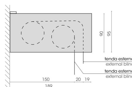
Fissaggio a soffitto. Ceiling fixing
