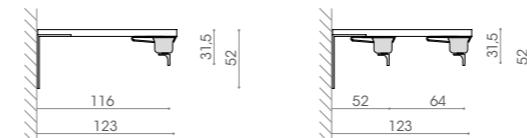
Fissaggio a soffitto. Ceiling fixing
