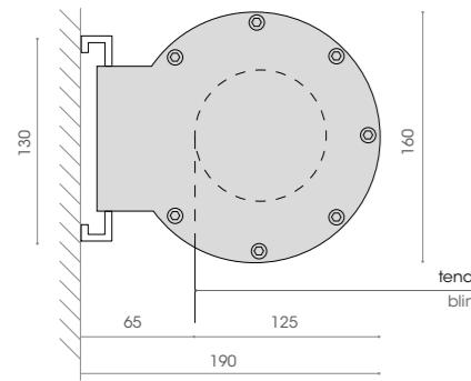
Fissaggio a soffitto. Ceiling fixing
